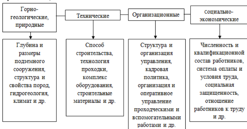
Рис. 1. Факторы, влияющие на технико-экономические показатели строительства подземных сооружений
